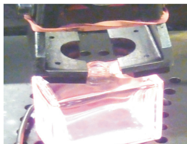
Вставки хватков горячего стекла из TECASINT
