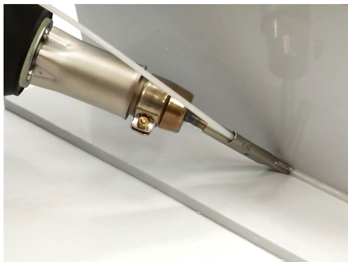
На фото два листа полипропилена, соединяемые с помощью ручного сварочного аппарата Quick-S-Electronic и полипропиленового сварочного прутка.
